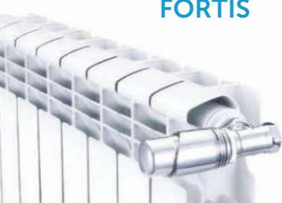
Биметаллические радиаторы Lavita сочетают в себе все преимущества алюминия и стали. Сталь делает продукцию устойчивой к коррозии и воздействию внешних факторов, а алюминий обеспечивает легкий вес и высокий уровень теплоотдачи. Благодаря стальному сердечнику не происходит контакт теплоносителя с алюминием. Такая конструкция препятствует выделению водорода и образованию шума. Радиаторы Fortis 500/350 обладают отличными характеристиками, сохранив превосходное качество и привлекательную цену.
